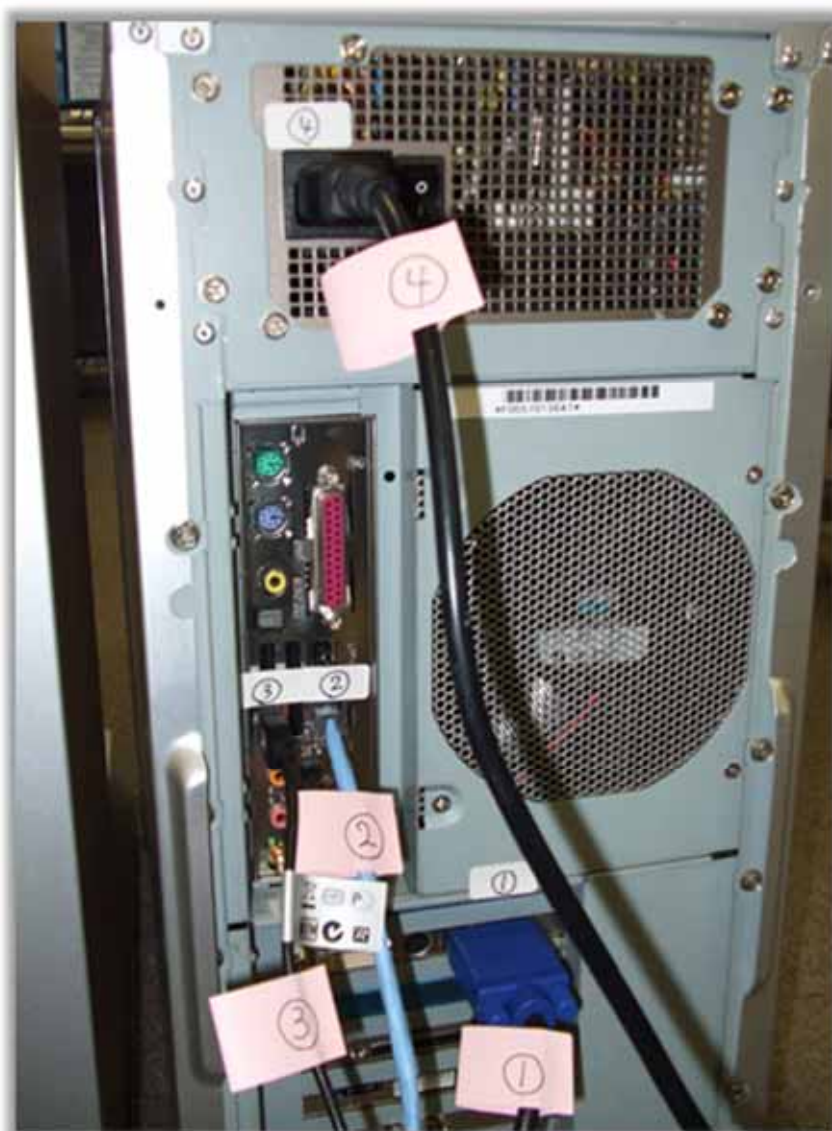
図3 ケーブル等へのラベル貼付状況の記録
